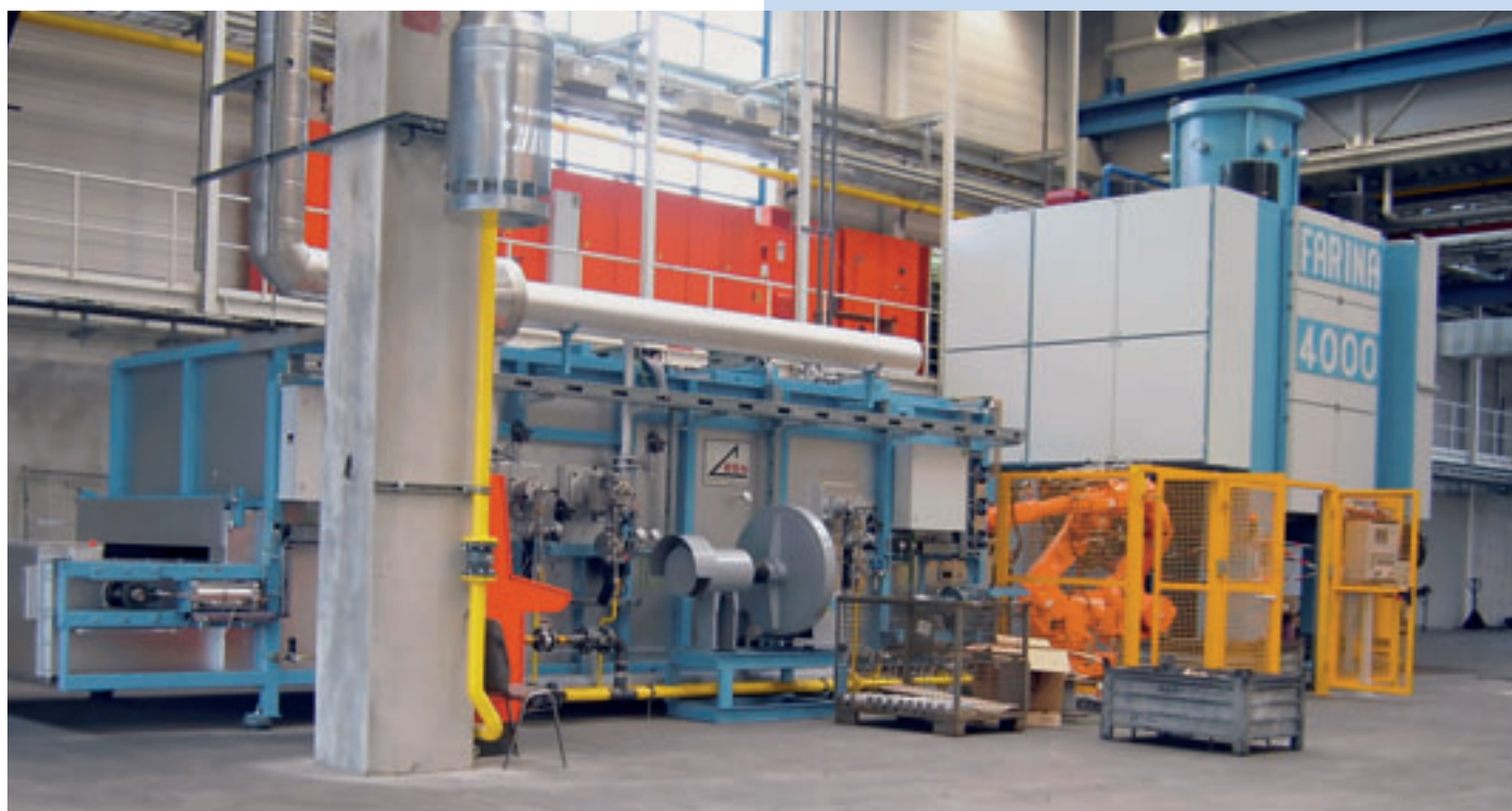
Im Aufbau – vollautomatische Schmiedelinie für Aluminium-Fahrwerksteile
