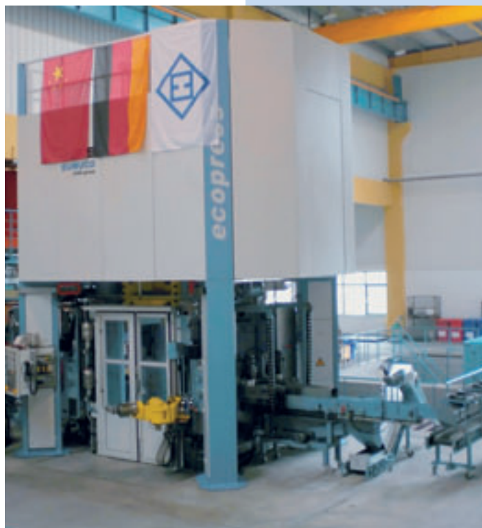
Die neue AMP 13, eine automatische 20 MN Presse für die Halbwarm- und Warmumformung in Pinghu
